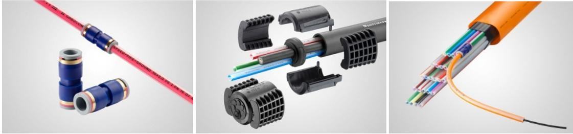
SNR werden sowohl in freien oder teilweise mit Kabeln belegten Zügen bestehender Kabelkanalanlagen als auch für direkte Verlegung im Erdreich eingesetzt. In die SNR werden spezielle Gf-Kabel mit geringem Außendurchmesser von  $\leq 6,5$  mm (Gf-Minikabel) oder  $\leq 2,6$  mm (Gf-Mikrokabel, FTTH), über einen Druckluftstrom eingeblasen.
