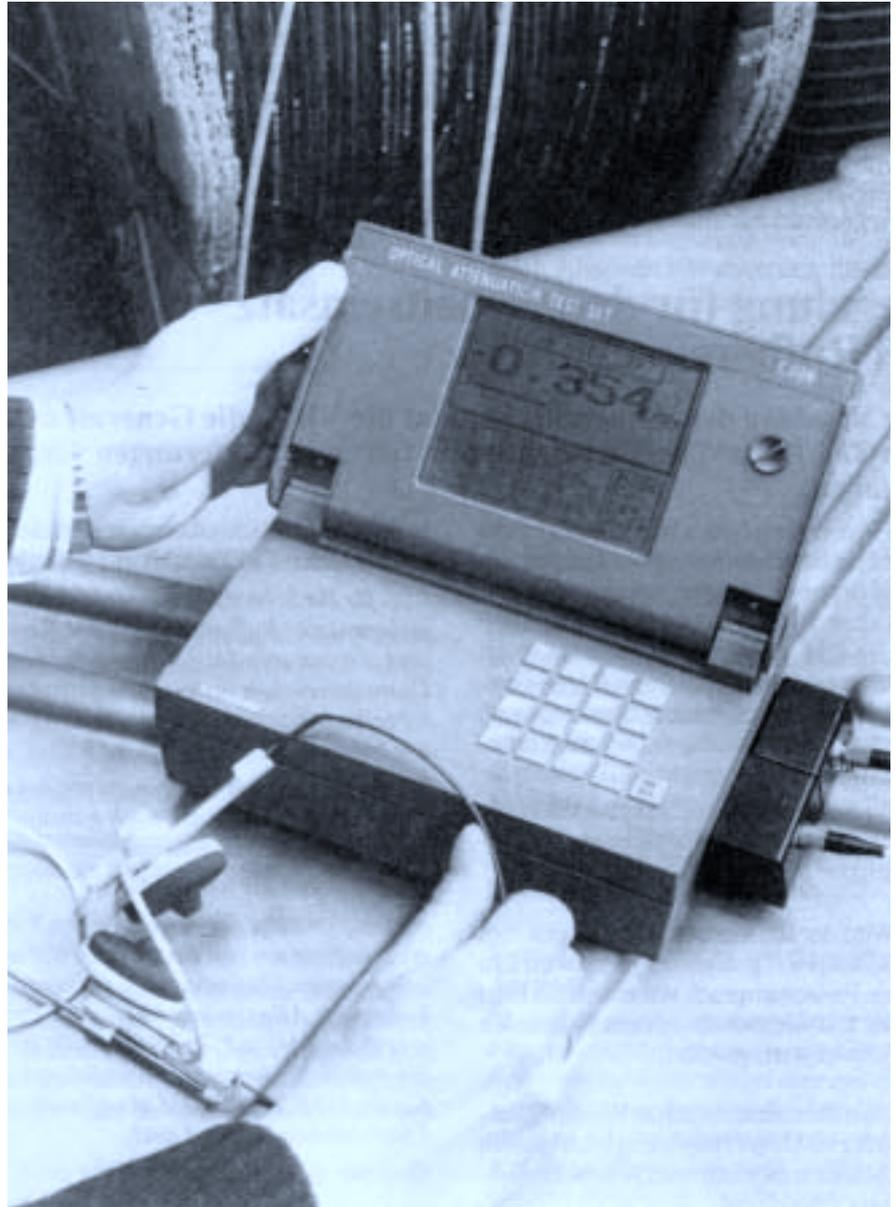
Der neue LWL-Meßplatz K 1186 von Siemens ist ein tragbares Meßgerät, das die optische Dämpfung, die Leistung und die Reflexionsdämpfung in Lichtwellenleitern mißt. Für Streckenmessungen läßt sich der K 1186 simultan als LWL-Telefon einsetzen. Ein grafikfähiges LC-Display zeigt die Meßwerte in Watt oder in Dezibel an.
